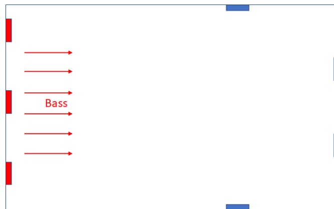
Abbildung 6: Richtung des Tieftons vom Signal der Frontkanäle
