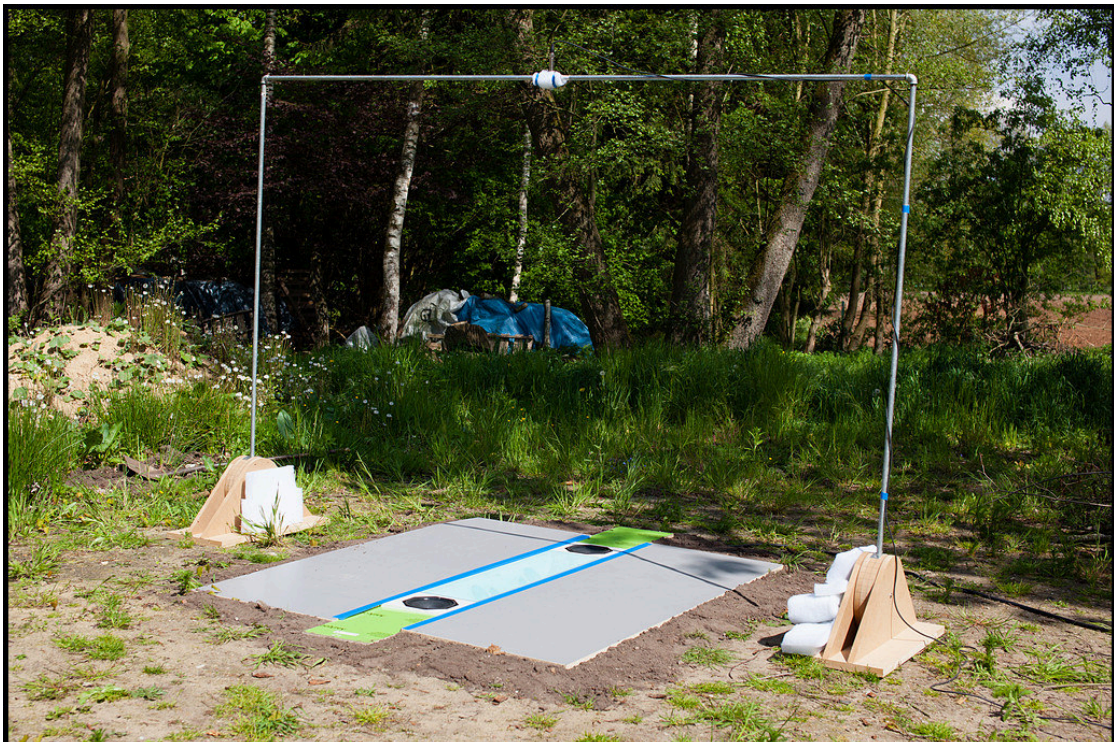
Abbildung 14: Messaufbau für Winkelmessungen
