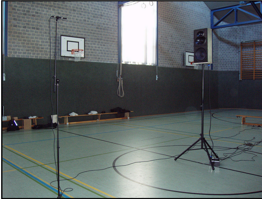
Abbildung 13: Messanordnung mit Messabstand von 3 m
