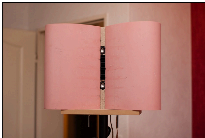
Abbildung 5: Prototyp 2 mit Planarwellenformer als Hochtöner
