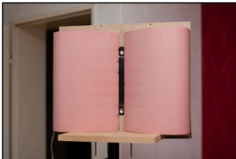
Abbildung 14: Prototyp 4 mit Dayton AMTPro-4
