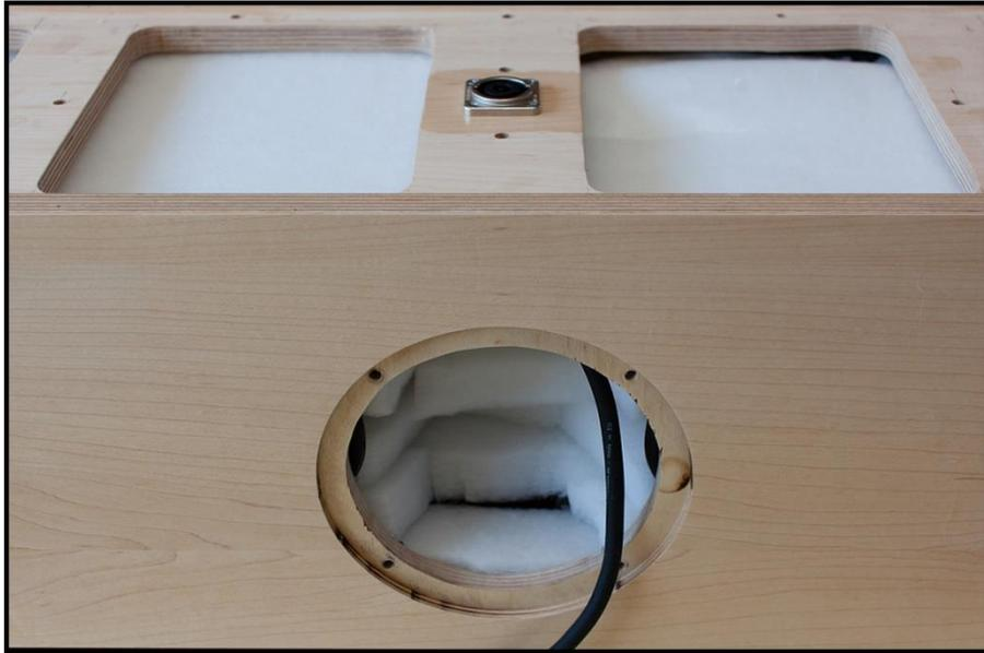
Abbildung 18: Füllung mit Iso Bond WLG 045
