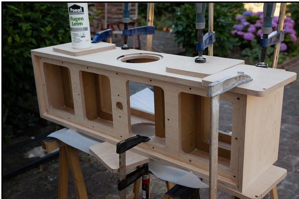
Abbildung 15: Verleimung des Gehäuses
