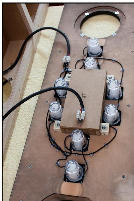
Abbildung 13: Angeschlossene Front
