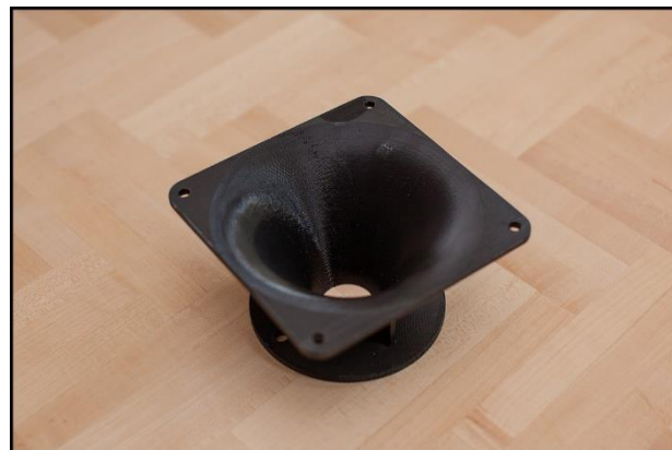
Abbildung 40: 3D-Druck des simulierten Horns
