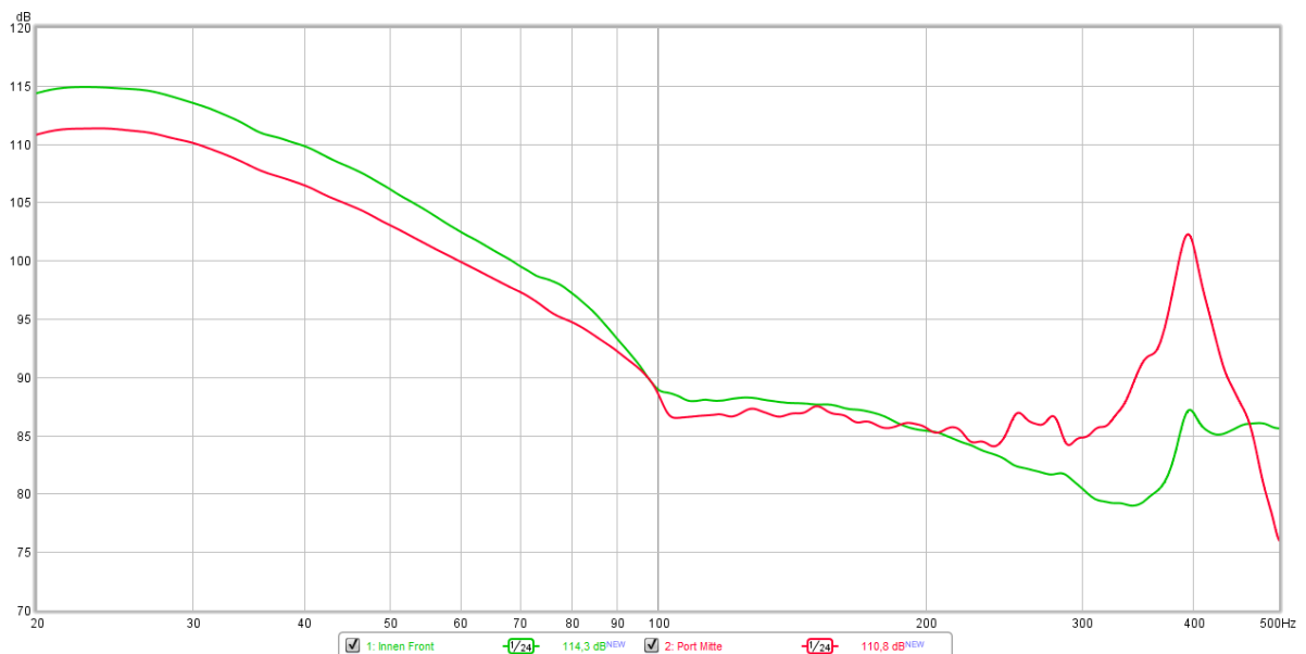
Abbildung 6: Amplitudengang im Gehäuse und in der Mitte des Bassreflexrohrs
